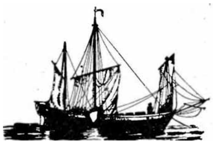
Раньшина – промысловое судно поморов. Имело 2–3 мачты. Грузоподъемность – 20–70 тонн.
